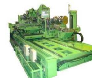
▲ クランクシャフト油穴明け専用BTAマシン
